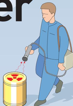
Robuste et doté d'une électronique très simple, le compteur Geiger-Müller est un outil de base pour la radioprotection.
